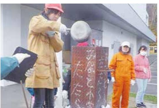
昔、製鉄所で働いていた鉄鋼マンが、日本伝統の「たたら製鉄」を伝えようと、小学校の課外授業やイベントでの体験教室を行っています。室蘭のイタンキ浜で原料となる砂鉄を集め、レンガと粘土で炉をつくり、木炭と砂鉄を入れて鉄ができる工程を学ぶことができます。
