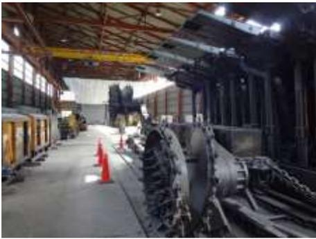
旧自走杵工場内の住友赤平炭鋳採炭用機械類（赤平市）。自走杵とは、それまで坑夫の手作業に頼っていた採炭を、効率的かつ大量に掘削するために開発された大型機械です。現在、自走杵は整備工場内で当時のまま、炭塵が付着した状態で保存されています。工場内には、住友赤平炭鋳で使用されていた大型の機械類が約 100 点展示されています。
